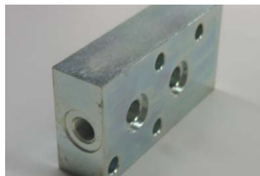
Рис. 2: Блок ответвления для клапана
